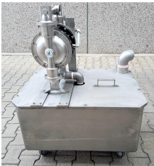
Trattasi in sostanza di un serbatoio carrellato in acciaio inox della capacità di 250 litri, all'interno del quale sarà posto un liquido speciale per decapaggio, che normalmente si trova in commercio.
